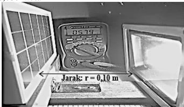
Gambar 5. Penyinaran cahaya lampu LED berjarak r = 0,10 meter
