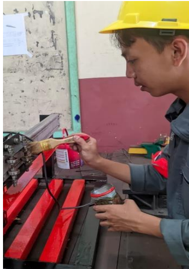
Gambar .6 Perawatan Pada Dudukan Mesin
